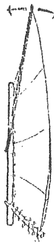
Spritoppen är vipp-topp. När det blåser i viker den av åt lä. Seglet släpper ut mera vind och rorsman får lättare att hindra båten från att kränga.
